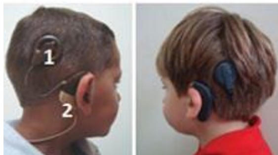
Sistema utilizado no implante coclear - 1) Antena transmissora 2) Processador de fala e microfone
