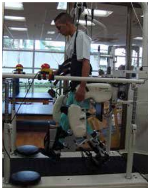
Paciente utilizando a Lokomat, criada para simular uma caminhada normal
