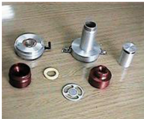
Imagem dos componentes do coletor de material particulado desmontado, composto por coletor, válvula agulha, bomba de vácuo, totalizador de vazão e medidor de vazão.
