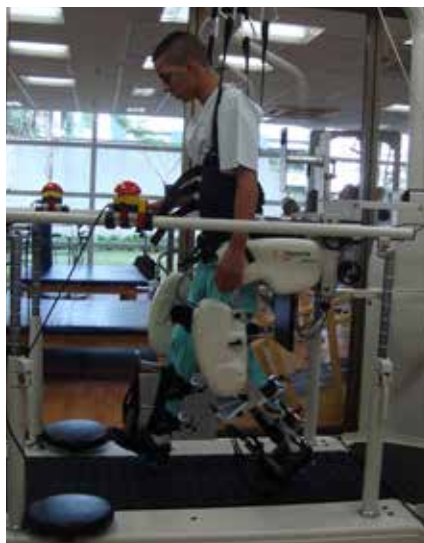
Um dos exercícios praticados por Felipe é na Lokomat, uma máquina criada para simular uma caminhada normal.
