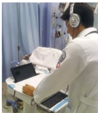
O equipamento reúne computador, sistema de transmissão de som e imagem e eletrocardiógrafo em um carrinho que acompanha o médico do pronto-socorro
